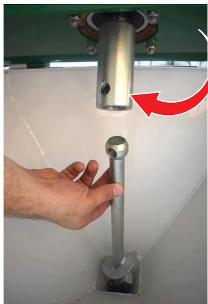
5. Alinhe os furos para inserir a trava da haste helicoidal (Fig. 16).
