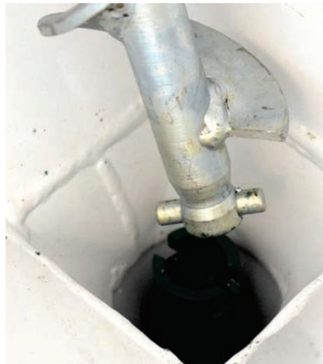
4. Articule o motor para realizar o encaixe da haste helicoidal no acoplamento do motor (Fig. 12)
