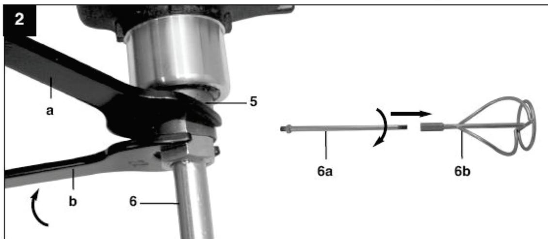
Primeiramente, rosqueie a haste (6<sup>a</sup>) com a pá (6<sup>b</sup>), apertando com uma chave. Em seguida, rosqueie a haste com a pá no misturador, Use as duas chaves inglesas (a e b) para fazer isso. Use uma das chaves para segurar o suporte do misturador no lugar e depois use a segunda chave para apertar o misturador. Continue na sequência inversa para retirar a haste.
