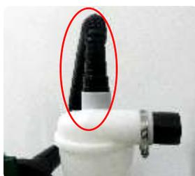
**4** Encaixe o saco coletor na lateral da turbina, conforme imagem abaixo:
